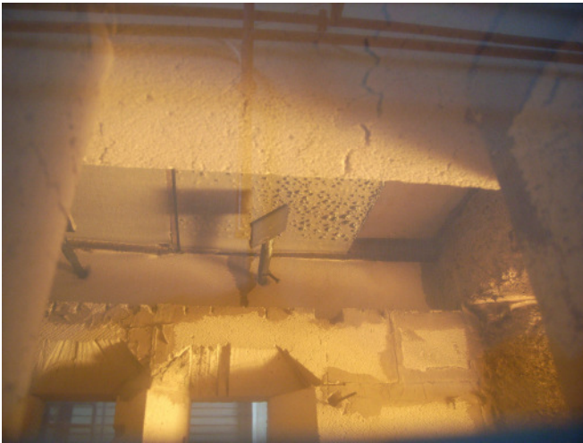
Bild 1: 1. Minute/F3, erste schwarze Verfärbung der Beschichtung
