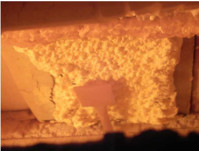
Bild 9: 60. Minute/F4, andauerndes schrumpfen und verbrennen der Beschichtung
