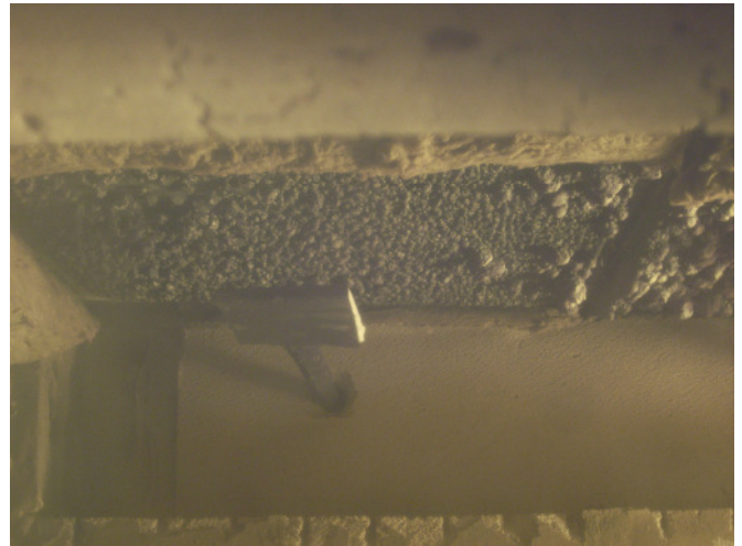
Bild 2: 3. Minute/F2, Beschichtungsoberfläche ist komplett schwarz gefärbt und schäumt pockenartig
