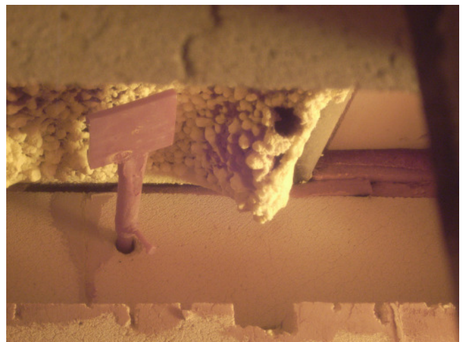
Bild 6: 27. Minute/F3, beginnendes Ablösen der Beschichtung an den Kanten der Teilflächen
