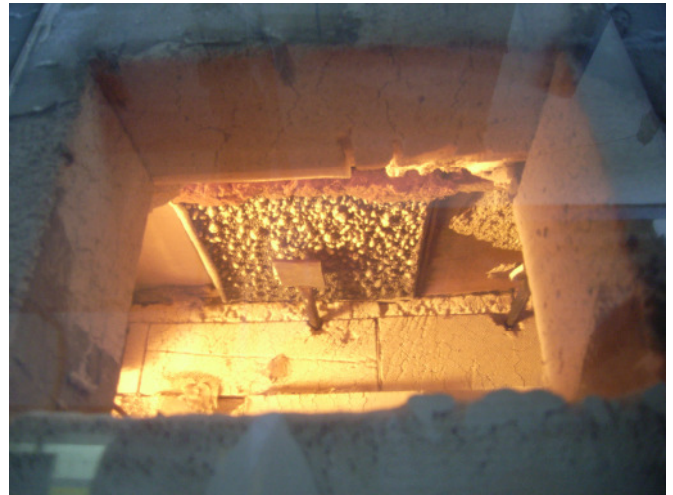
Bild 4: 14. Minute/F4, beginnende Weißfärbung der Beschichtungsoberflächen
