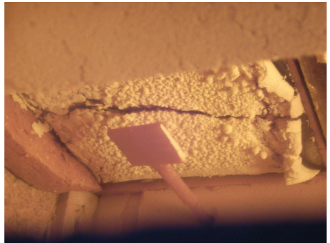
Bild 8: 50 Minute/F2, aufreißen der Beschichtung
